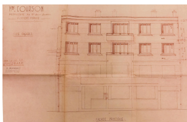
Surélévation d'un immeuble, deux étages supplémentaires (1965) Repro. Félicie Fougère , Autr. Elie Marquet IVR84_20256302161NUCA
