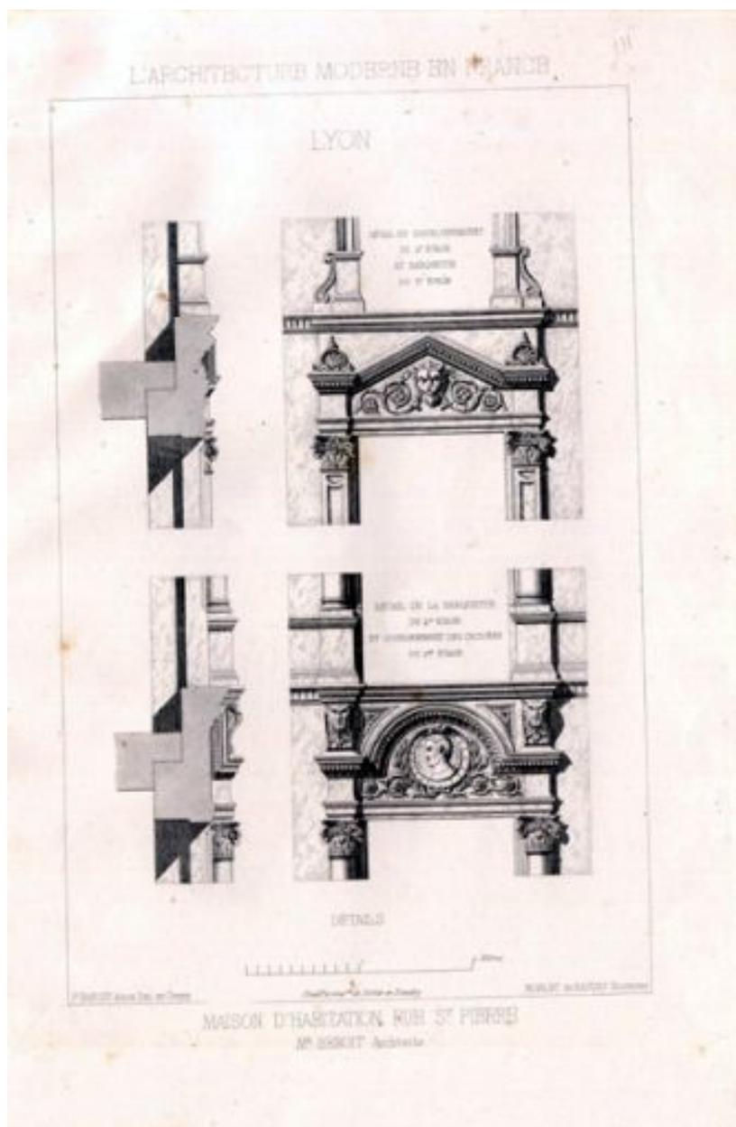
Maison d'habitation rue St-Pierre (...) Détails. Détail du couronnement du 2e étage et banquette du 3e. Détail de la banquette du 2e étage et couronnement des croisées du 1er étage, par F. Barqui. Dans : L'architecture moderne en France, 1871, pl. 111
