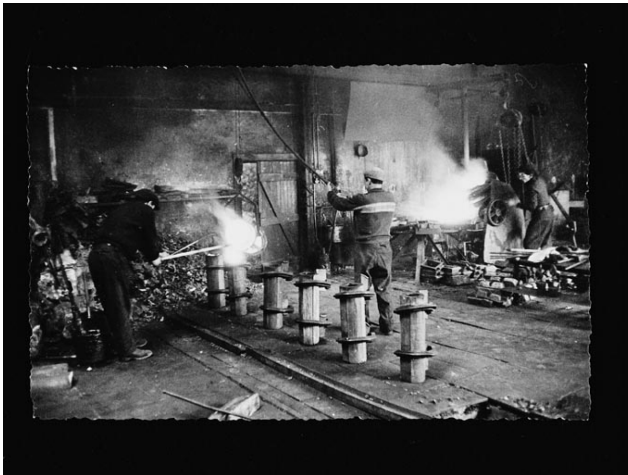
Fonderie, cuivre en fusion dans un creuset, versé dans des lingotières, archives privées DLMI
