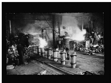
Fonderie, cuivre en fusion dans un creuset, versé dans des lingotières, archives privées DLMI Repro. Jean-Marie Refflé IVR82_19996900818XB
