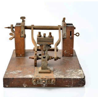
Machine à tailler les engrenages, vue 2 Phot. Thierry Leroy IVR84_20256901802NUCA
