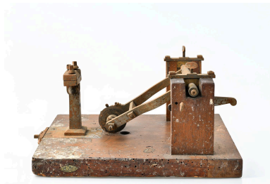
Machine à tailler les engrenages Phot. Thierry Leroy IVR84_20256901801NUCA
