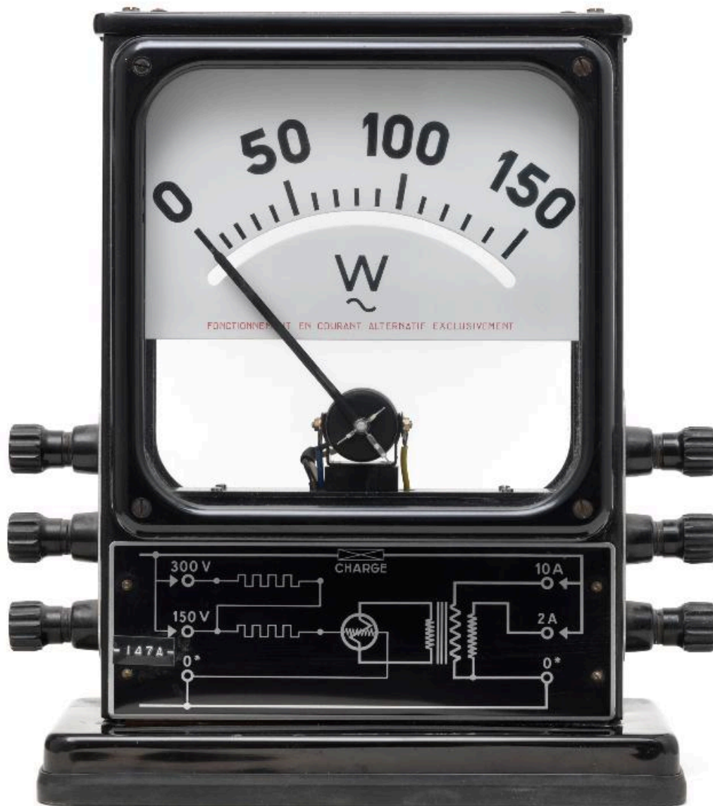
Vue avant du wattmètre
