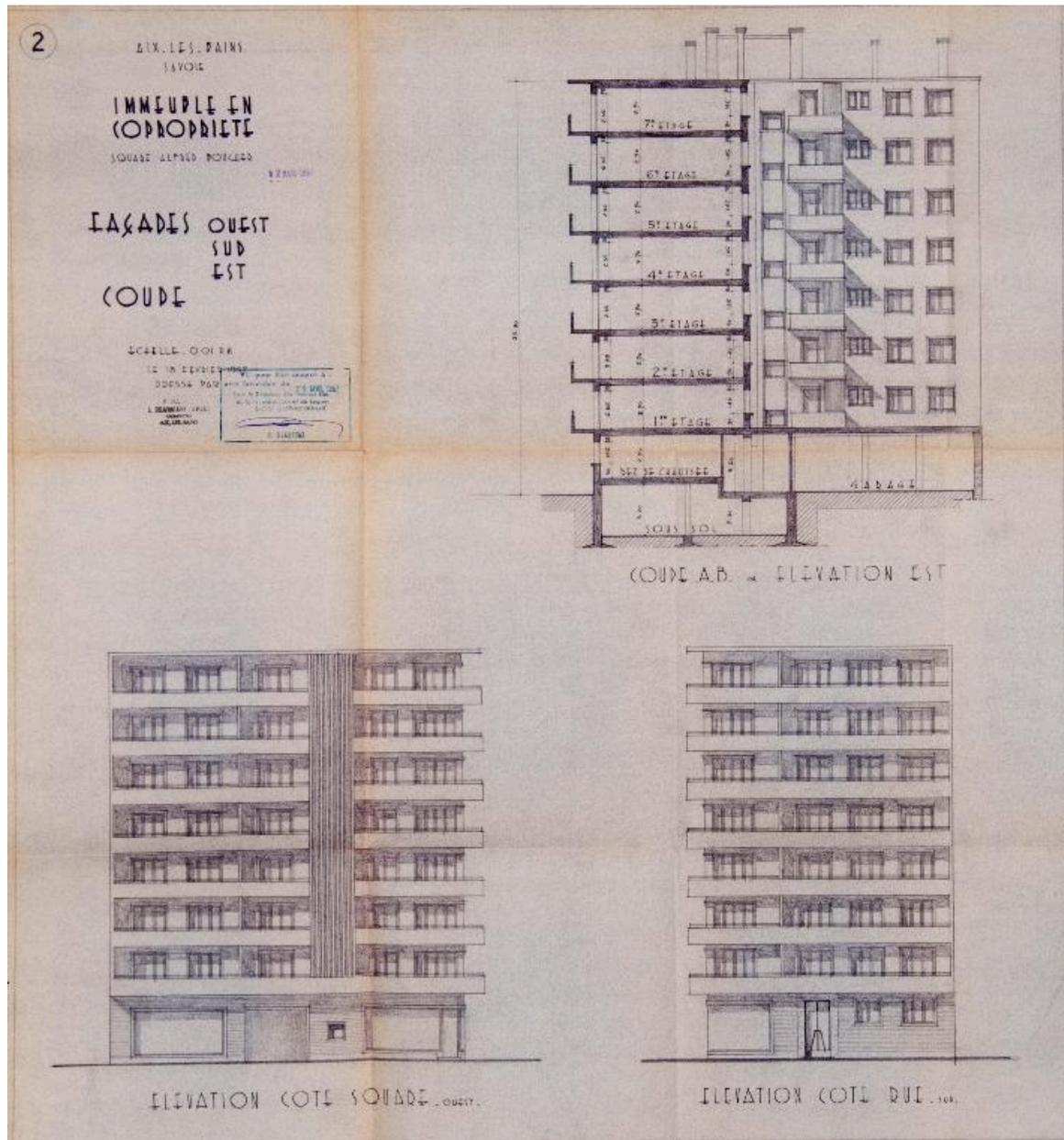
Immeuble Le Régent et garage de réparation automobile. Élévations et coupe, 1957
