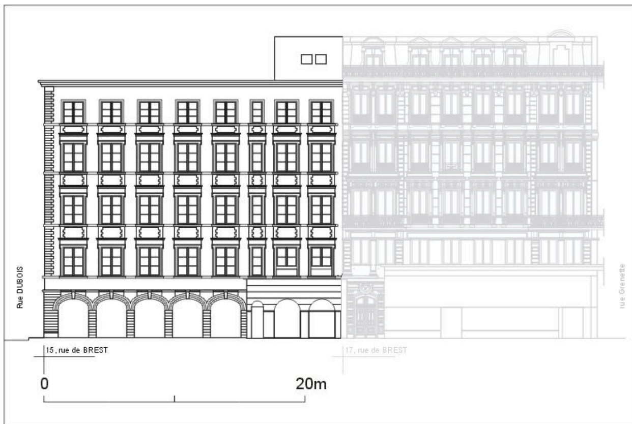
Elévation de la façade sur la rue de Brest, d'après un relevé photogrammétrique par A. Bensaci, 2003
