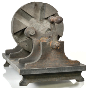
Engrenage à cônes, vue 2 Phot. Thierry Leroy IVR84_20256901826NUCA
