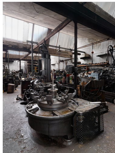
Machine Lorenz : taillage dent par dent Phot. Aurélie Dessert IVR82_20106902313NUCA
