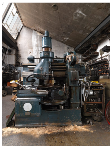
Machine Fellows : taillage par outil-couteau (va plus vite) Phot. Aurélie Dessert IVR82_20106902315NUCA
