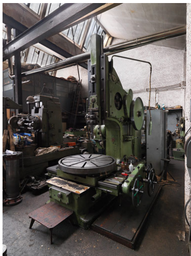
Machine Butler : mortaisage Phot. Aurélie Dessert IVR82_20106902309NUCA
