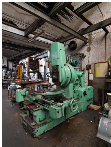
Machine MAAG : taillage par génération (1 cycle) pièce de 1 m de diamètre Phot. Aurélie Dessert IVR82_20106902306NUCA
