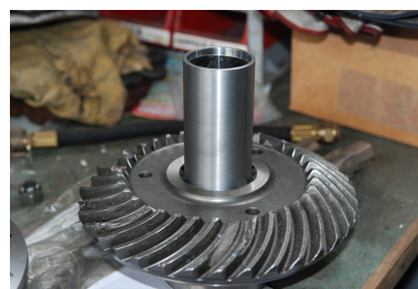
Engrenage avec dentelure spiro-conique Phot. Nadine Halitim-Dubois IVR82_20106900590NUCA
