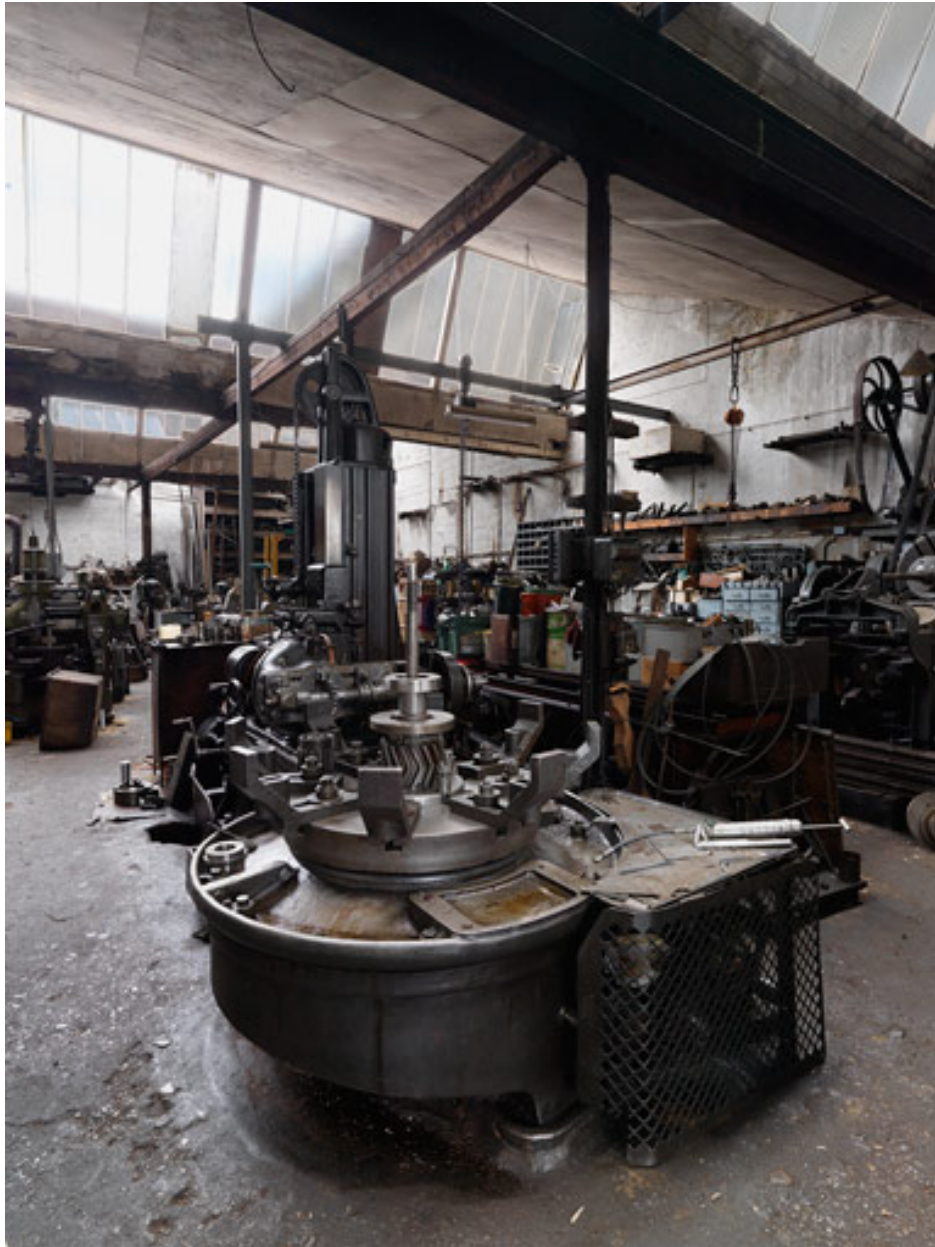
Machine Lorenz : taillage dent par dent
