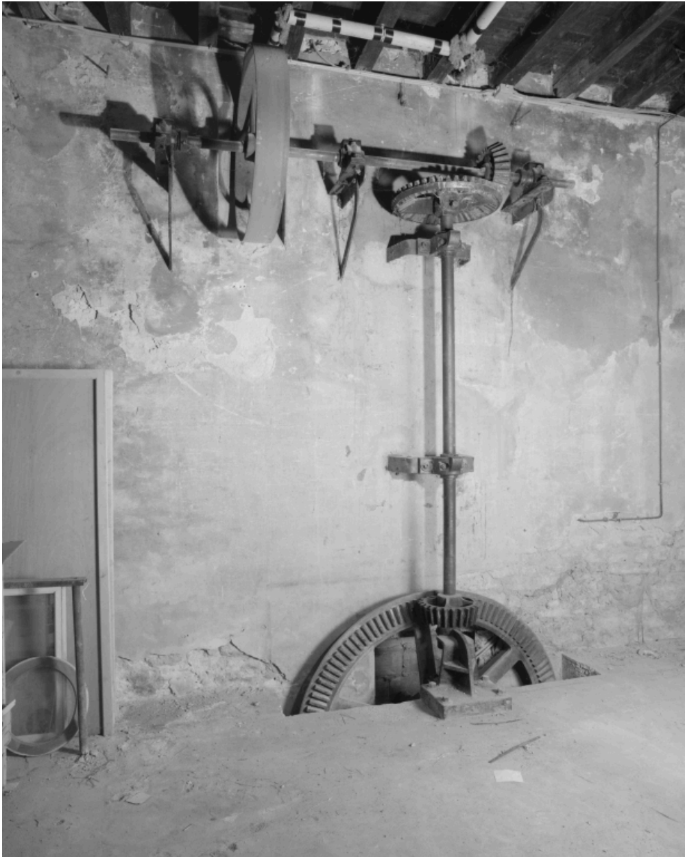
Engrenage situé dans les ateliers, relié à une turbine.
