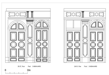
Elévation des façades sur la rue Paul-Chenavard, détail des portes, d'après un relevé photogrammétrique par A. Bensaci, 2003 Dess. Paul Cherblanc IVR82_20056902808NUD
