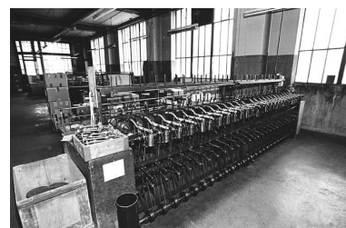
Rouet volette, pour fil très fin (type soie), le rouet tourne très lentement Phot. Patrick Ageneau IVR82_19996900789Z
