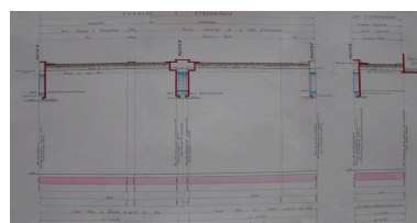
Amélioration du service des eaux, conduite de siphonage, 1939. Plan. Archives départementales de la Haute-Savoie © Archives départementales de la Haute-Savoie. 2 O 787/10 Phot. Samir Mahfoudi IVR82_20107400288NUCA
