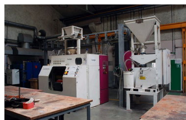
Boîte à noyaux automatisée et malaxeur LAEMPE Phot. Catherine Guégan IVR82_20116901923NUCA
