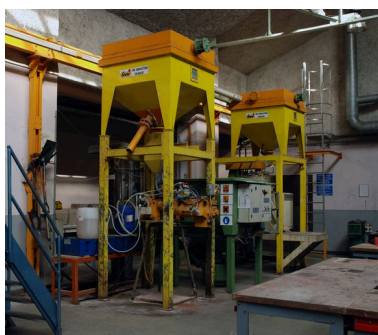
Préparateur et malaxeur de sable chimique FM INDUSTRIE et ARABAMENDI Phot. Catherine Guégan IVR82_20116901922NUCA
