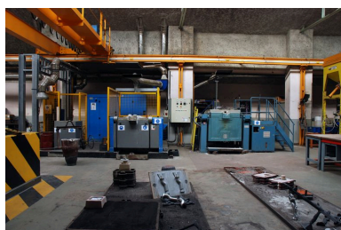
Four à aluminium et four à fonte Phot. Catherine Guégan IVR82_20116901921NUCA
