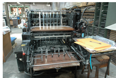
Heidelberg Cylindre (typo), vue avant sur la table de marge. Phot. Nadine Halitim-Dubois IVR82_20096901797NUCA
