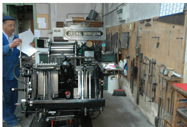
Heidelberg Platine (typo), chargement du papier sur la table de marge. Phot. Nadine Halitim-Dubois IVR82_20096901787NUCA
