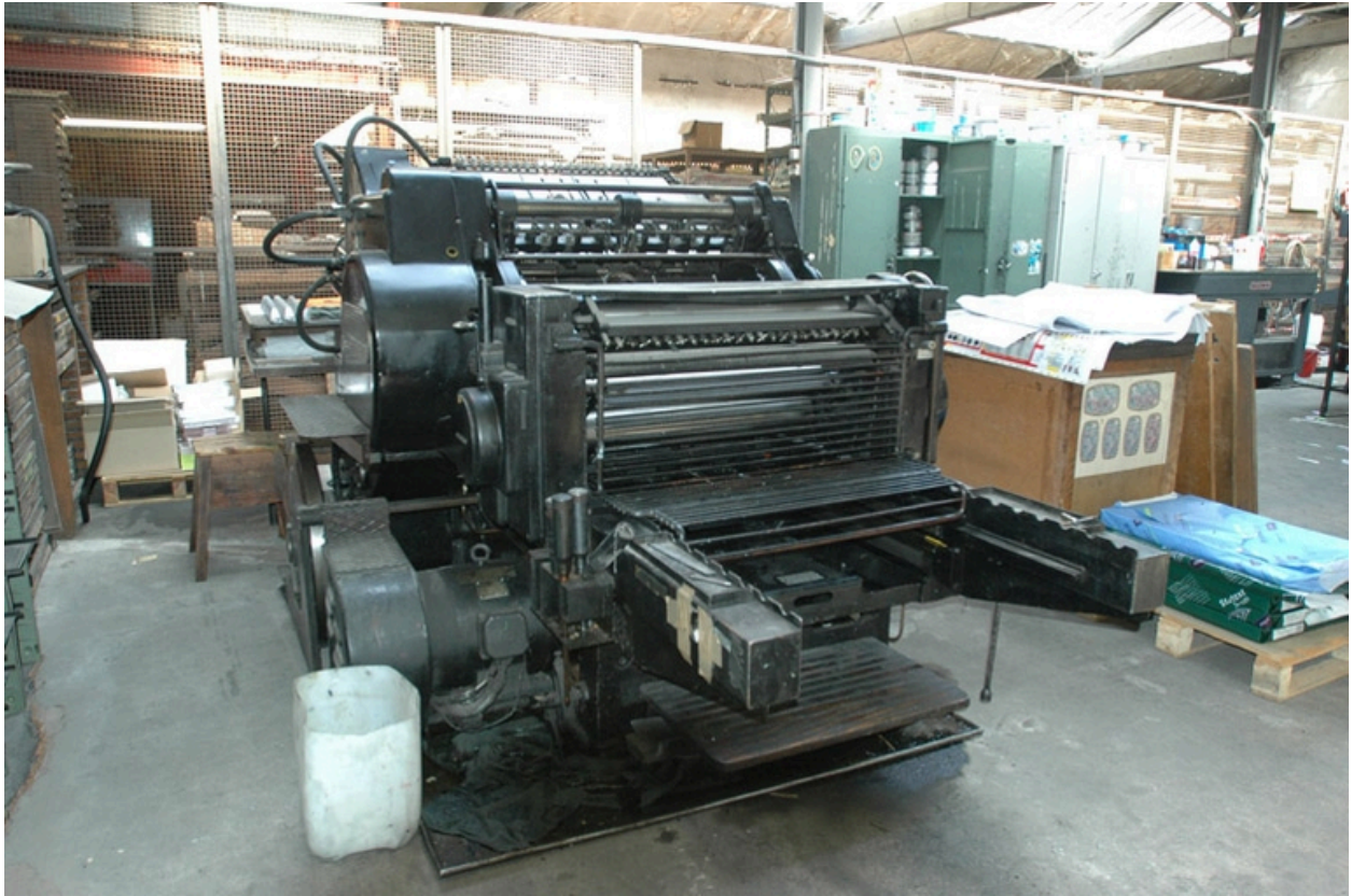
Heidelberg Cylindre (typo), vue arrière sur les cylindres d'impression.
