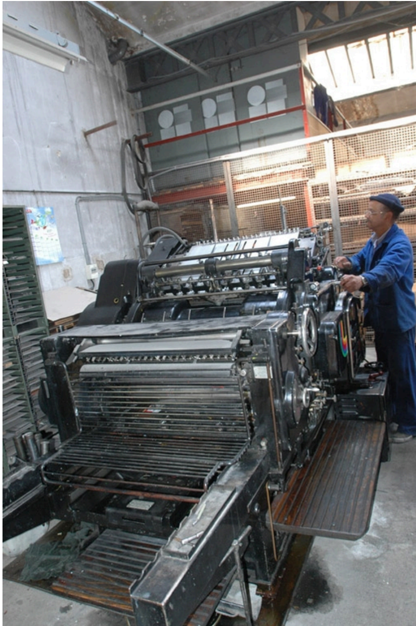
Heidelberg Cylindre (typo), mise en marche par le typographe.
