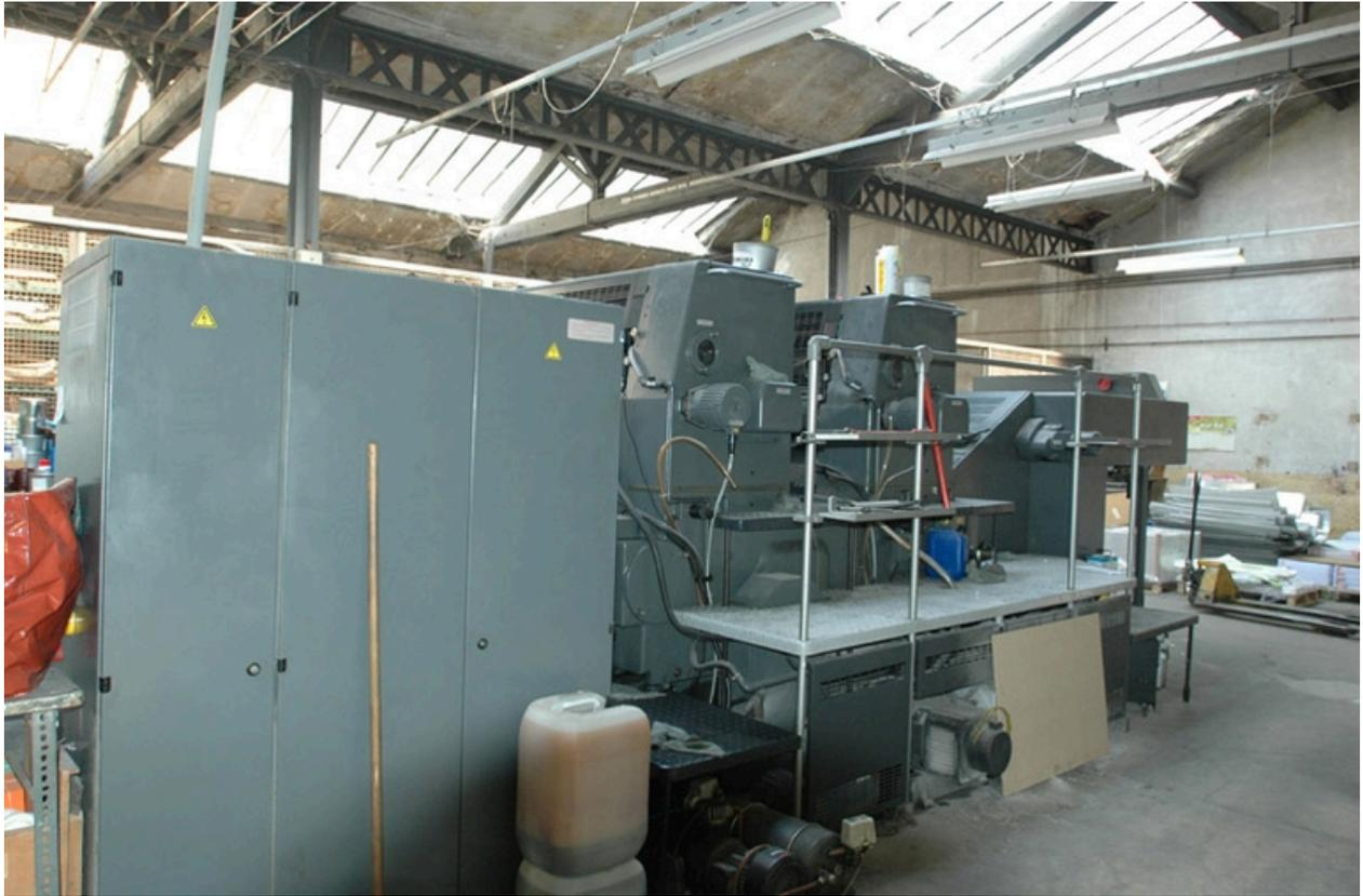
Machine offset quatre couleurs, vue de coté (cf n°1 sur le plan).
