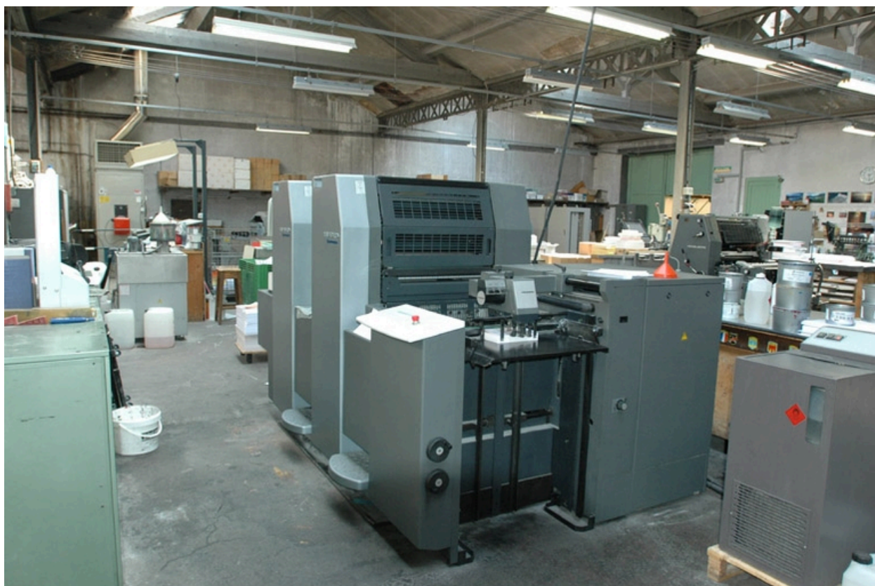
Machine offset deux couleurs, vue de coté, (cf n°3 sur le plan).
