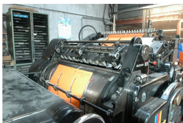
Heidelberg Cylindre (typo), détail des cylindres d'impression, machine en marche. Phot. Nadine Halitim-Dubois IVR82_20096901809NUCA
