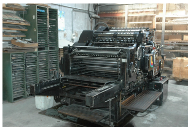
Heidelberg Cylindre (typo), vue d'ensemble. Angle nord ouest de l'atelier. Phot. Nadine Halitim-Dubois IVR82_20096901798NUCA
