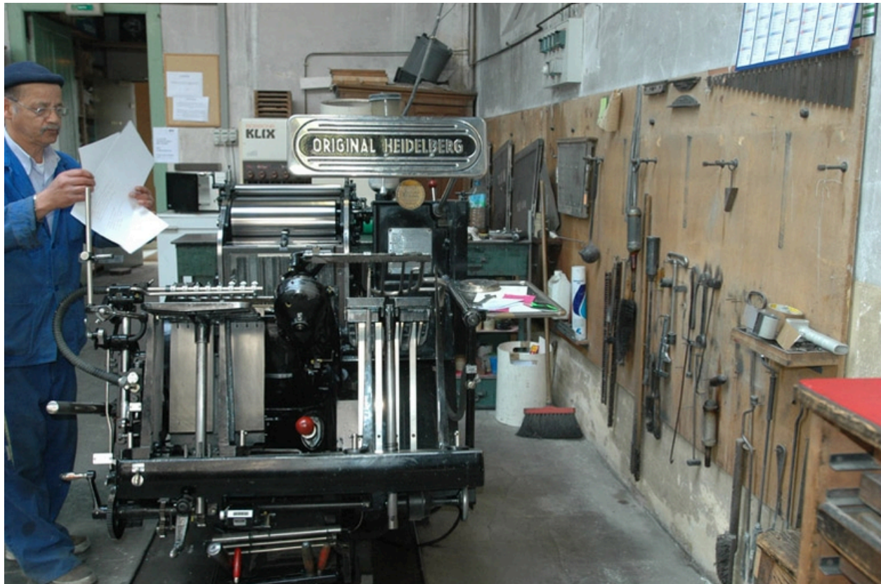
Heidelberg Platine (typo), chargement du papier sur la table de marge.
