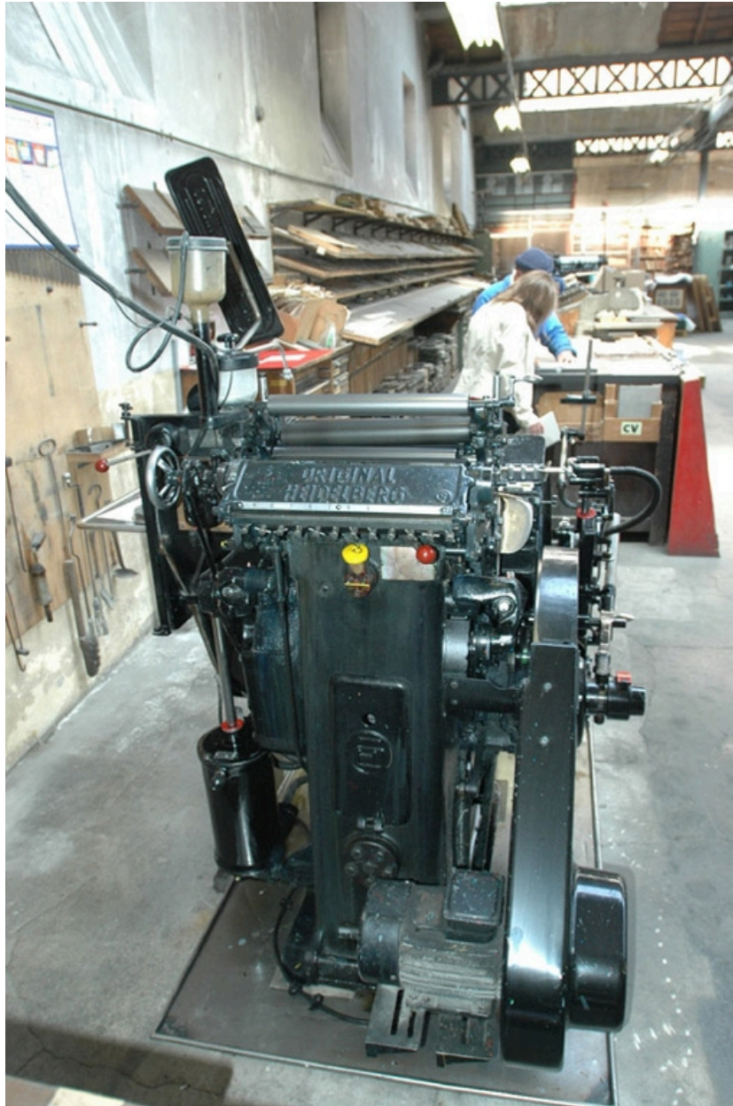
Heidelberg Platine (typo), vue arrière sur les rouleaux à encre.
