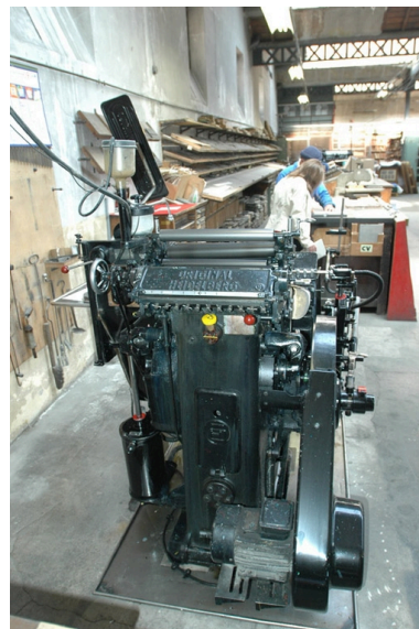
Heidelberg Platine (typo), vue arrière sur les rouleaux à encre. Phot. Nadine Halitim-Dubois IVR82_20096901784NUCA
