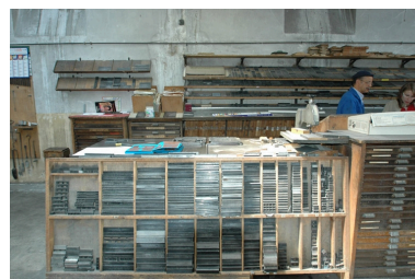
Meubles de rangement des lingots et des caractères typographiques. Phot. Nadine Halitim-Dubois IVR82_20096901806NUCA
