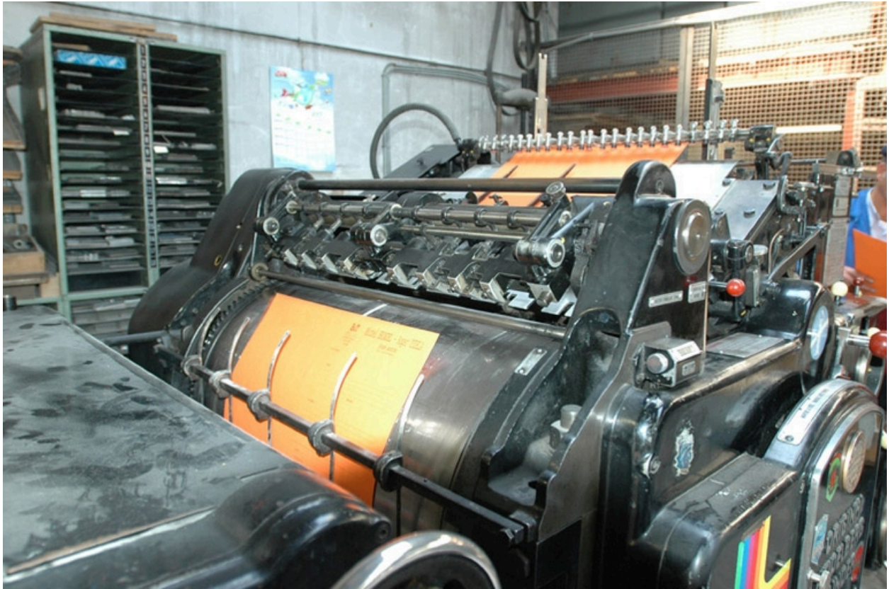
Heidelberg Cylindre (typo), détail des cylindres d'impression, machine en marche.
