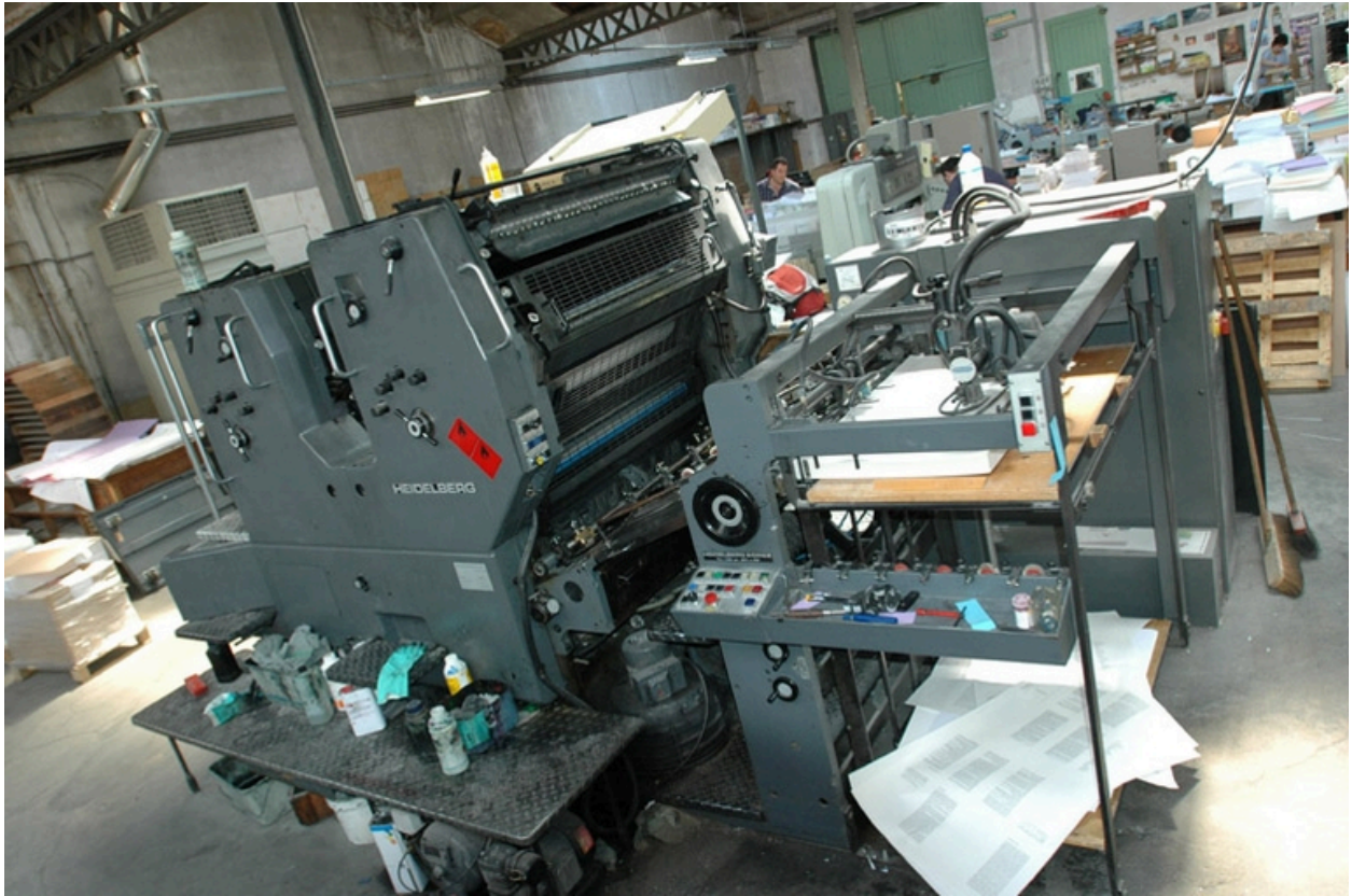
Machine offset quatre couleurs, table de marge, vue du dessus, (cf n°2 sur le plan)
