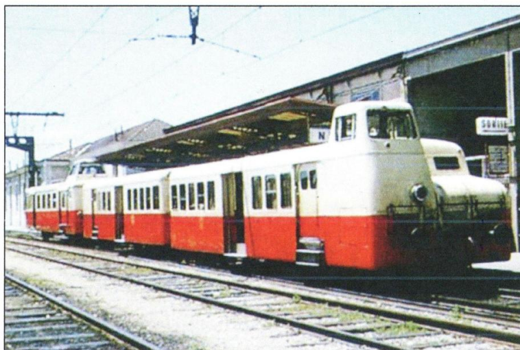
Au premier plan, un autorail FNC 80 ch. est attelé à une remorque et à un U 150, en gare de Nîmes.
