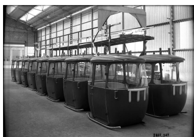
S.N.A.V. - chaîne de fabrication de cabines-œuf de remonter mécanique (archive Association Viniciacum) Phot. Alice Giacovelli IVR84_20226900456NUC
