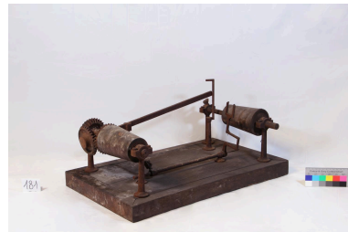
Variateur de vitesse, vue de côté Phot. Krystelle Besson , Phot. Mirco Meier, Phot. Marion Petit IVR84_20256901277NUCA
