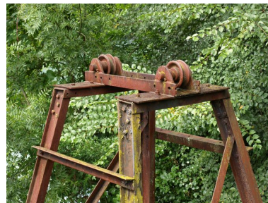
Treuil, vue partielle : poulie Phot. B. Decrock IVR82_20100100156NUCA
