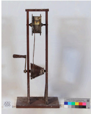
Principe de fusée, vue de face, n°188 Phot. Krystelle Besson , Phot. Mirco Meier, Phot. Marion Petit IVR84_20256901287NUCA
