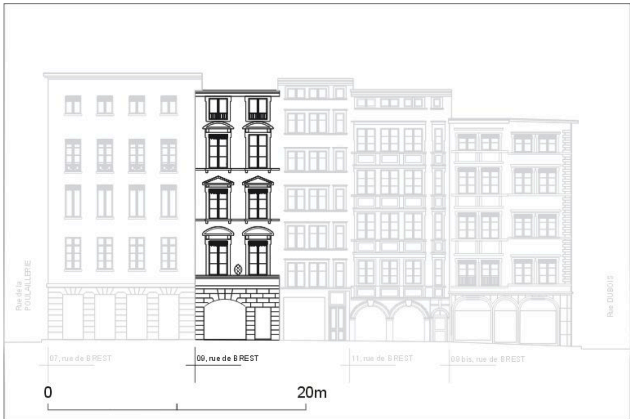
Elévation de la façade principale, d'après un relevé photogrammétrique par A. Bensaci, 2003
