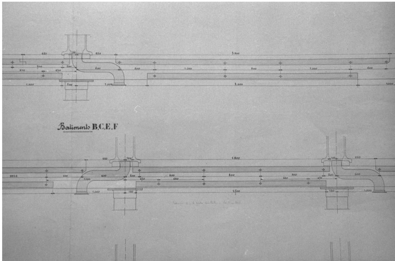
Aquarelle sur tirage sur papier. Bâtiment d'exploitation. Fourrures en sapin et trompes d'air chaud dans les poutres du rez-de-chaussée
