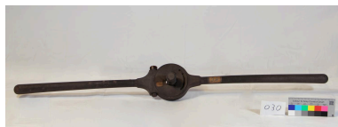
Clé de taraud ou filière (objet 030) Phot. Krystelle Besson , Phot. Mirco Meier, Phot. Marion Petit IVR84_20256901011NUCA
