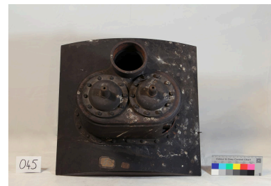
Modèle de valves haute pression (objet 045) Phot. Krystelle Besson , Phot. Mirco Meier, Phot. Marion Petit IVR84_20256901041NUCA
