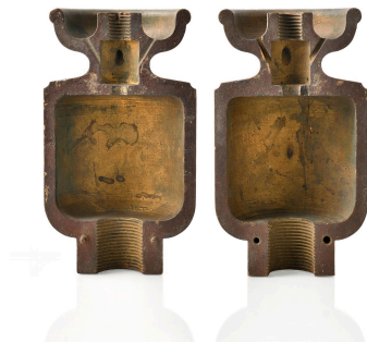
Modèle de graisseur, vue 1, en coupe Phot. Thierry Leroy IVR84_20256901765NUCA
