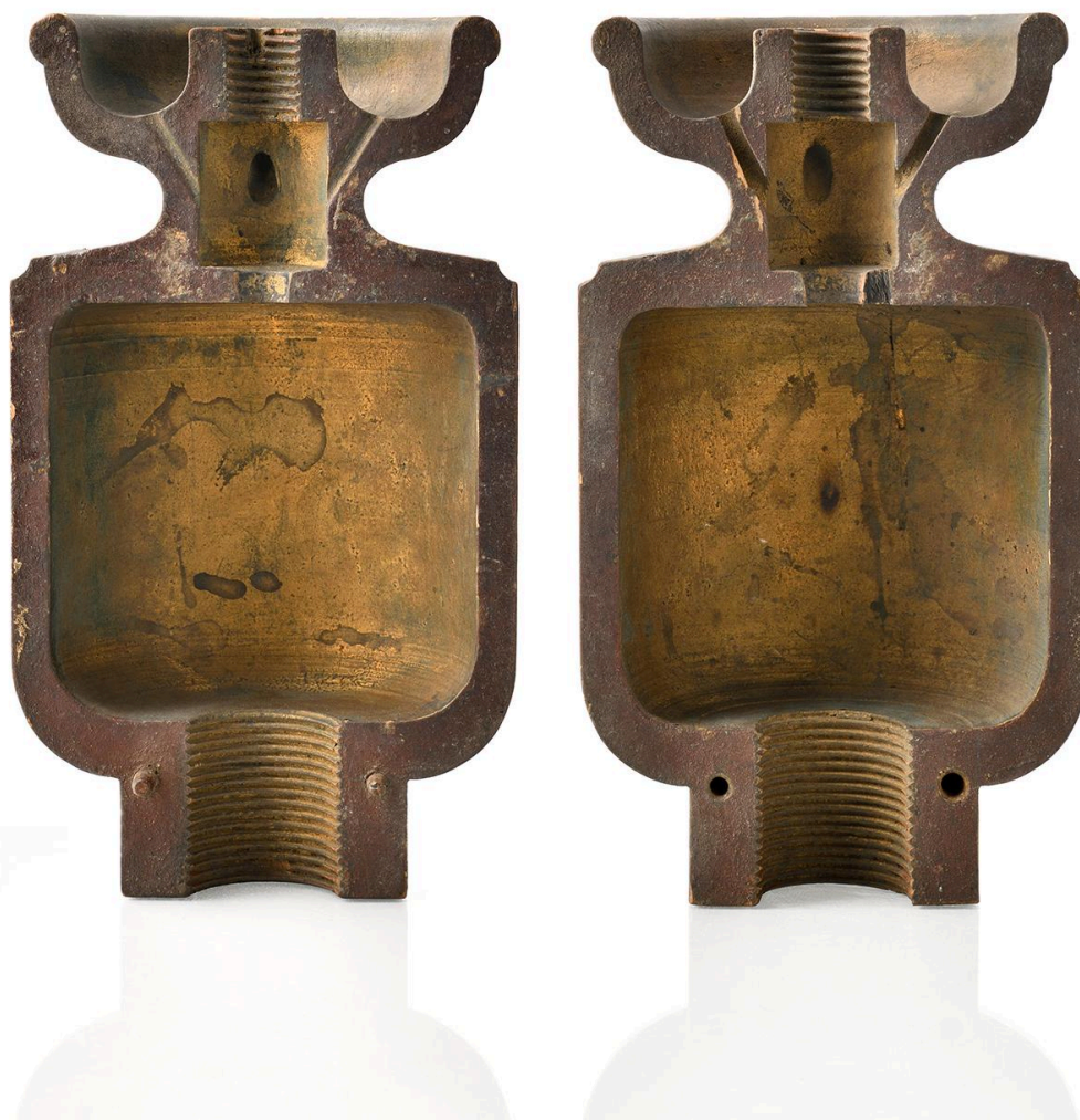
Modèle de graisseur, vue 1, en coupe
