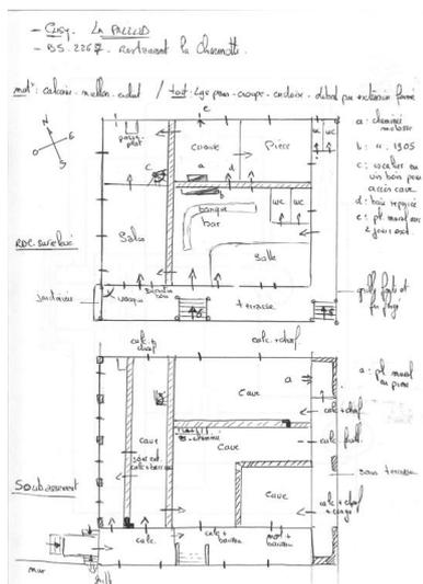
Relevé schématique de l'étage de soubassement et du rez-de-chaussée surélevé du restaurant.
