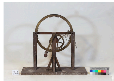
Modèle de roue de démultiplication, vue de face Phot. Krystelle Besson , Phot. Mirco Meier, Phot. Marion Petit IVR84_20256901144NUCA
