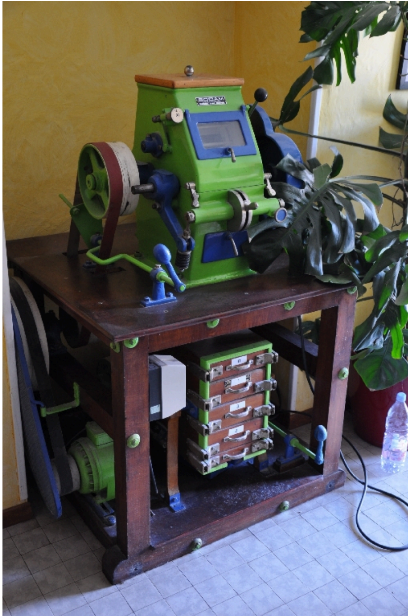
Moulin de laboratoire utilisé pour des démonstrations
