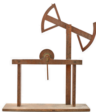
Transmission de mouvement alternatif, vue 2 Phot. Thierry Leroy IVR84_20256901775NUCA
