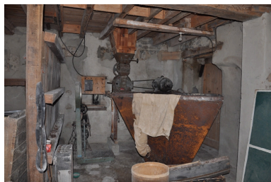
Broyeur à marteau, modèle TYPMK2 de la marque OLYMPIA Phot. Yannick Milleret IVR82_20097300253NUCA
