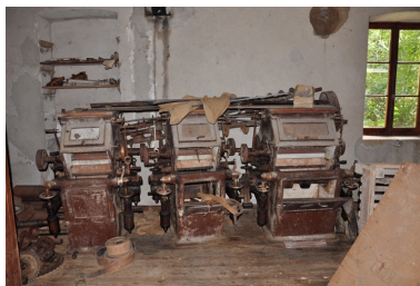
Broyeur à cylindres, H&G. ROSE FRERES Phot. Yannick Milleret IVR82_20097300254NUCA
