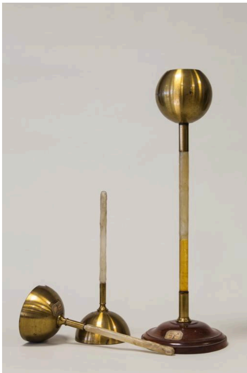
Sciences physiques : hémisphère de Coulomb ou de Cavendish pour expérience de Biot (à droite) ; 2 sphères de Cavendish (à gauche)
