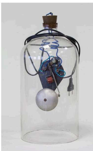
Sciences physiques : timbre électrifié sous cloche pour l'étude de la propagation du son dans le vide. Phot. Pascal Lemaître IVR82_20152600184NUCA
