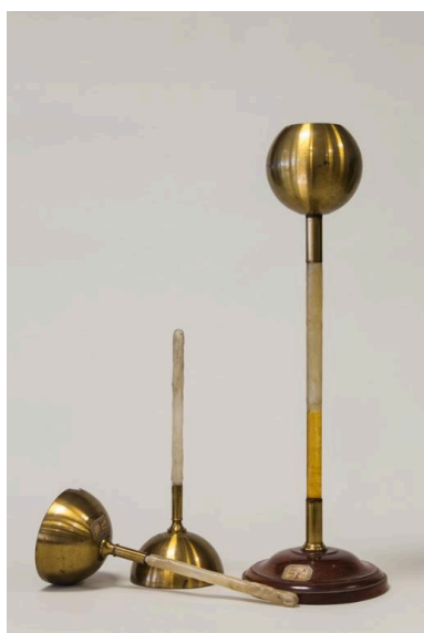
Sciences physiques : hémisphère de Coulomb ou de Cavendish pour expérience de Biot (à droite) ; 2 sphères de Cavendish (à gauche) Phot. Pascal Lemaître IVR82_20152600210NUCA
