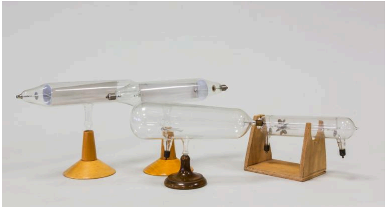
Sciences physiques : 2 tubes de Crookes à croix de Malte ; 2 tubes de Geissler (ou de Plücker)
