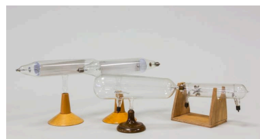
Sciences physiques : 2 tubes de Crookes à croix de Malte ; 2 tubes de Geissler (ou de Plücker) Phot. Pascal Lemaître IVR82_20152600191NUCA
