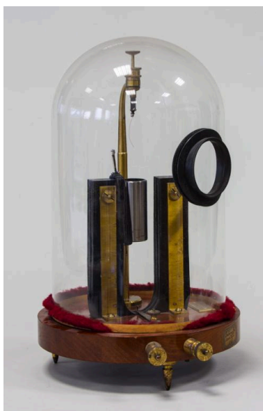
Sciences physiques : galvanomètre d'Arsonval sous sa cloche Phot. Pascal Lemaître IVR82_20152600197NUCA
