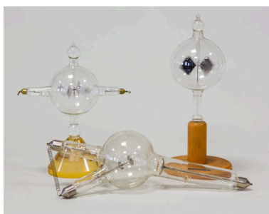
Sciences physiques : tube à rayons X ; tube de Crookes avec roue phosphorescente Phot. Pascal Lemaître IVR82_20152600199NUCA
