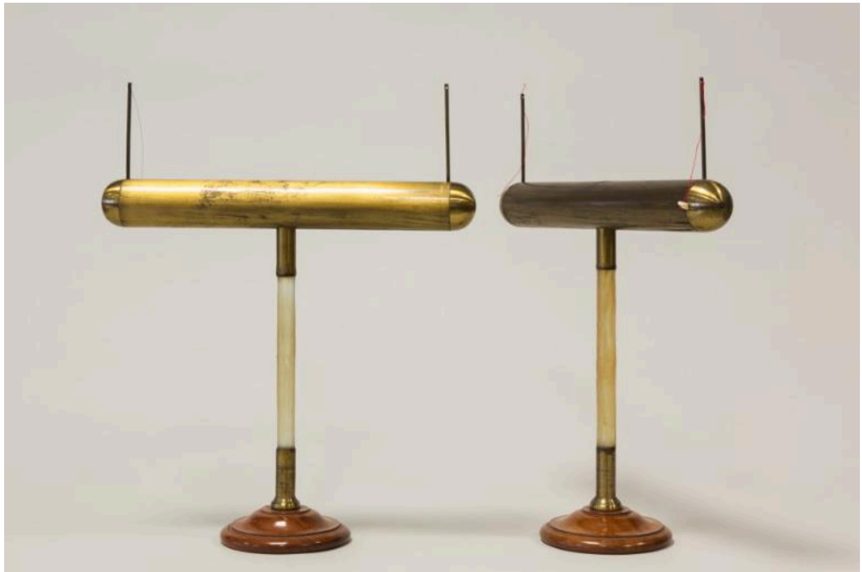
Sciences physiques : 2 cylindres isolés d'Aepinus
