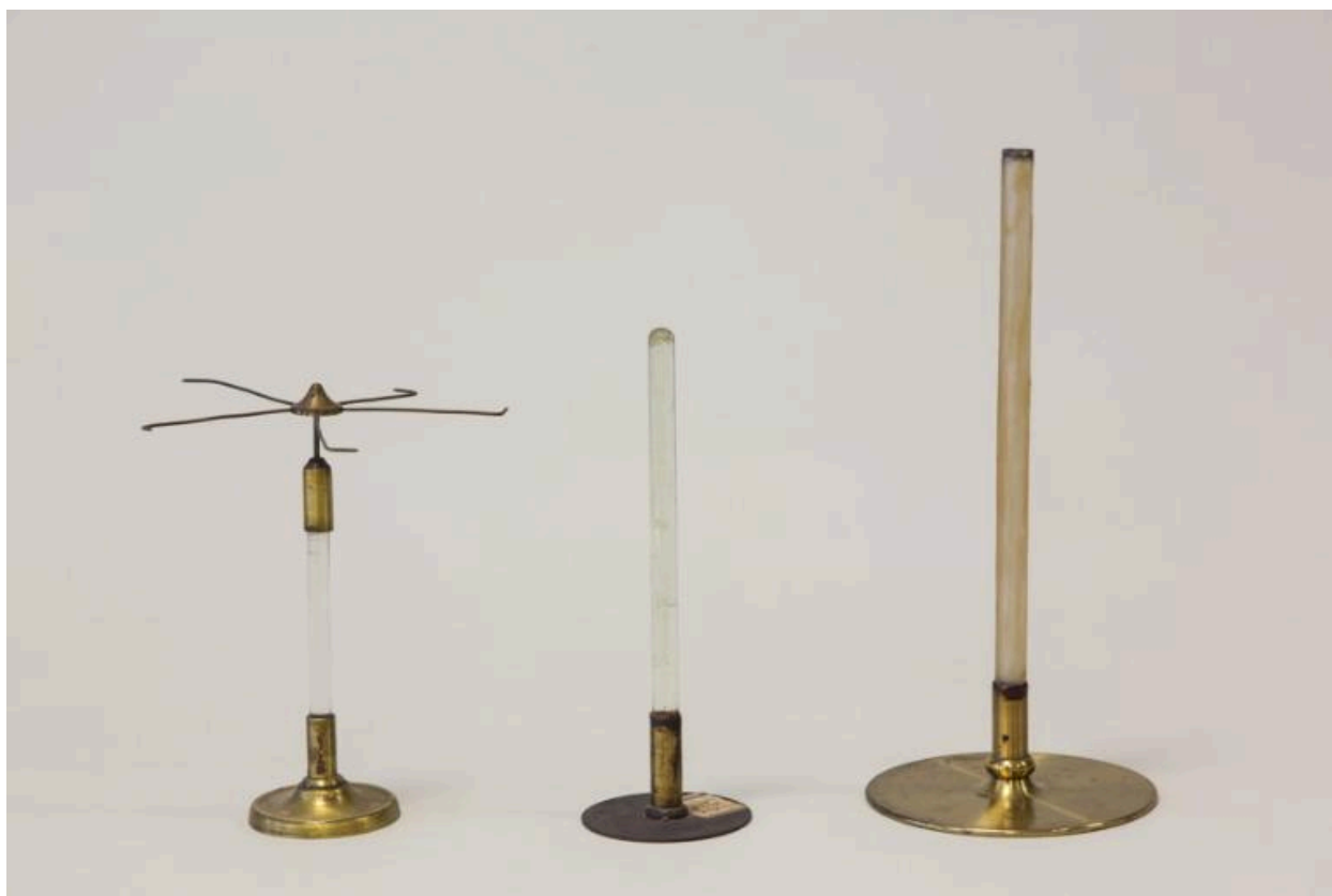
Sciences physiques : tourniquet électrique ; manche isolant, Thurneyssen et Ducretet & Roger
