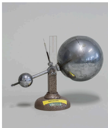
Baroscope n°2 des établissements Eurosap-Deyrolle Phot. Pascal Lemaître IVR82_20147303436NUCA
