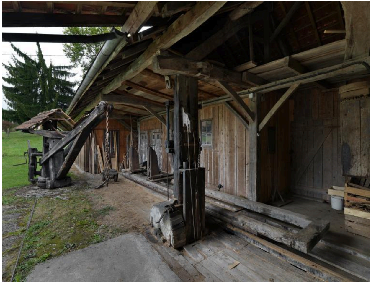
Vue du chariot et de l'entraînement de la lame battante.
