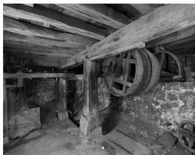
Vue intérieure du sous-sol : système d'entraînement de la lame battante et du chariot, axe de la roue à aubes. Phot. Thierry Leroy IVR84_20167306214NUCQ
