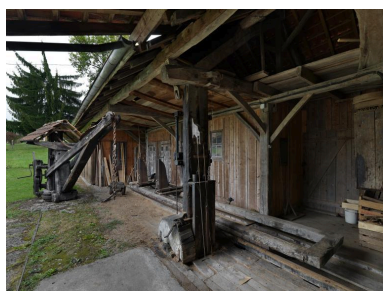
Vue du chariot et de l'entraînement de la lame battante. Phot. Thierry Leroy IVR84_20167306193NUCAQ
