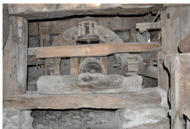
Vue des engrenages de la roue dont l'arbre est en bois. Phot. Clara Bérelle IVR82_20147303185NUCA
