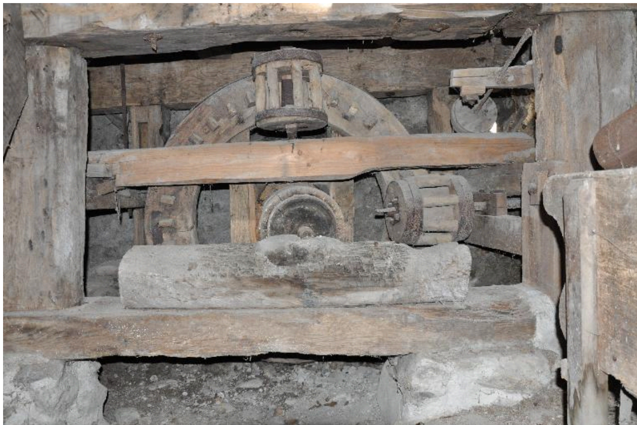
Vue des engrenages de la roue dont l'arbre est en bois.
