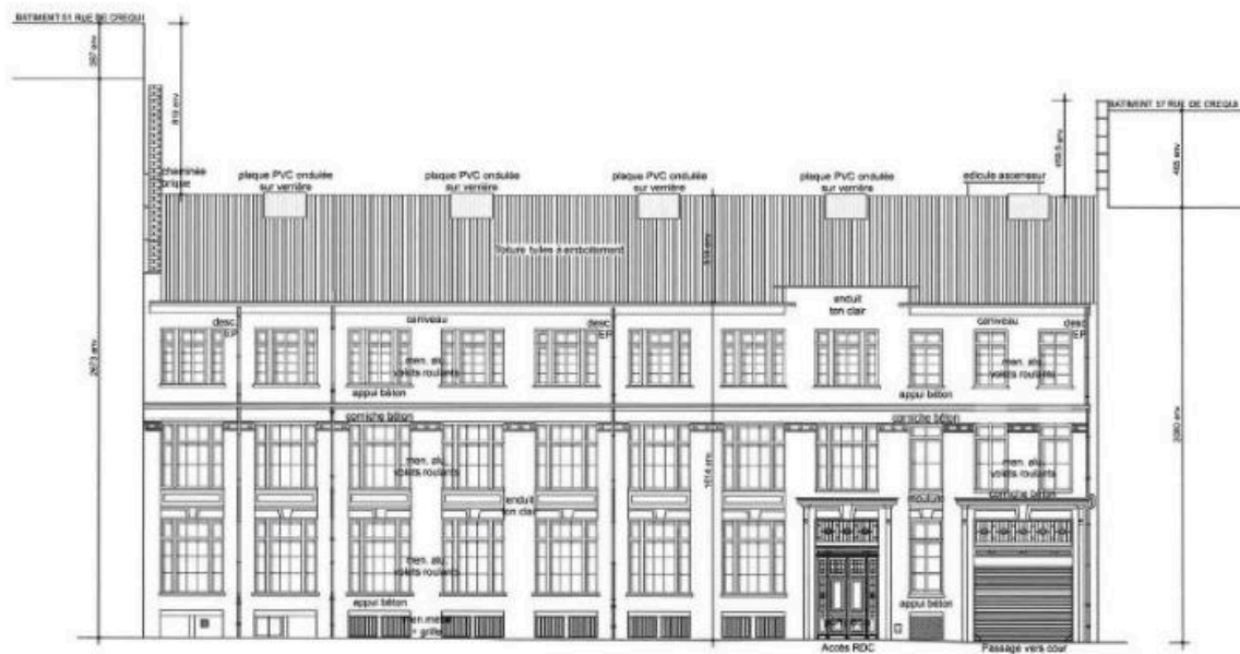
Façades sud-ouest état des lieux (doc Région AURA)
