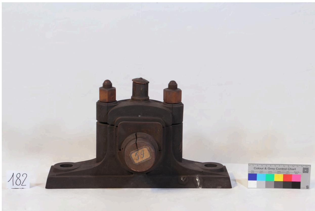
Modèle de palier-axe vue de face
