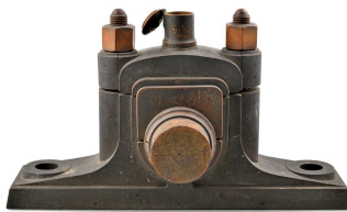
Modèle de palier avec graisseur, vue 2 Phot. Thierry Leroy IVR84_20256901784NUCA
