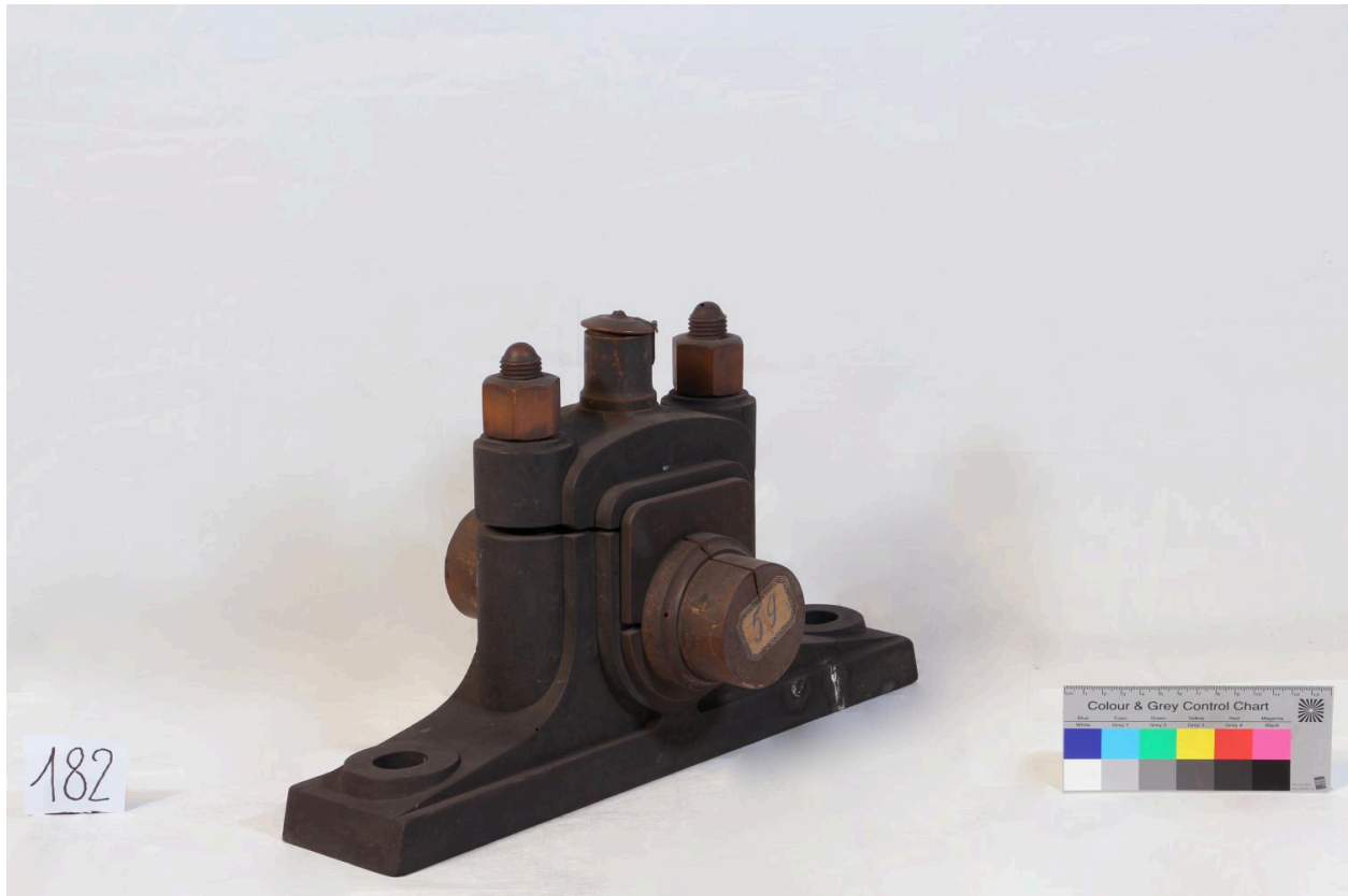
Modèle de palier-axe, vue de côté
