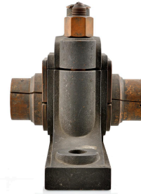
Modèle de palier avec graisseur, vue 3 Phot. Thierry Leroy IVR84_20256901785NUCA
