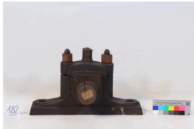
Modèle de palier-axe vue de face Phot. Krystelle Besson , Phot. Mirco Meier, Phot. Marion Petit IVR84_20256901278NUCA
