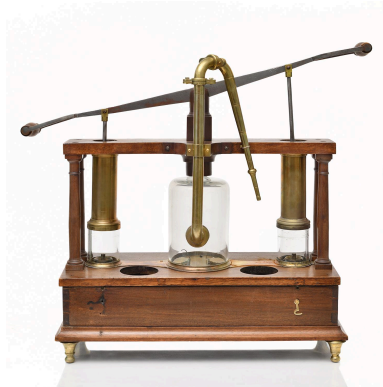
Pompe à double corps, vue 1 Phot. Thierry Leroy IVR84_20256902011NUCA
