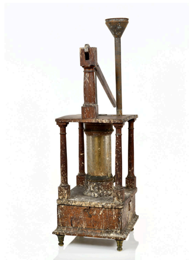
Pompe aspirante et foulante, vue 3 Phot. Thierry Leroy IVR84_20256901817NUCA
