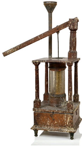
Pompe aspirante et foulante, vue 4 Phot. Thierry Leroy IVR84_20256901818NUCA
