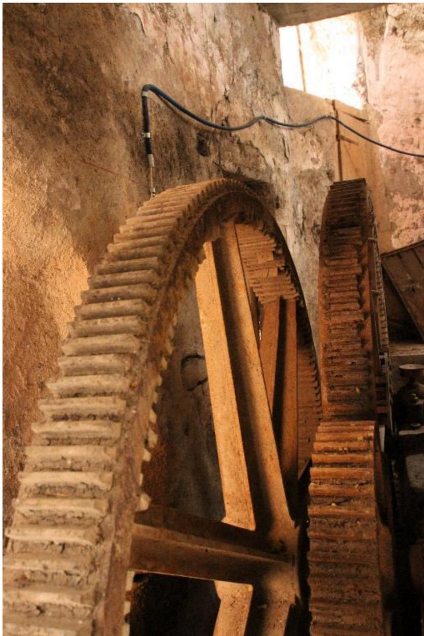
Enchassées dans les murs de l'ancienne chapelle, les roues crantées sont actionnées depuis la roue à augets
