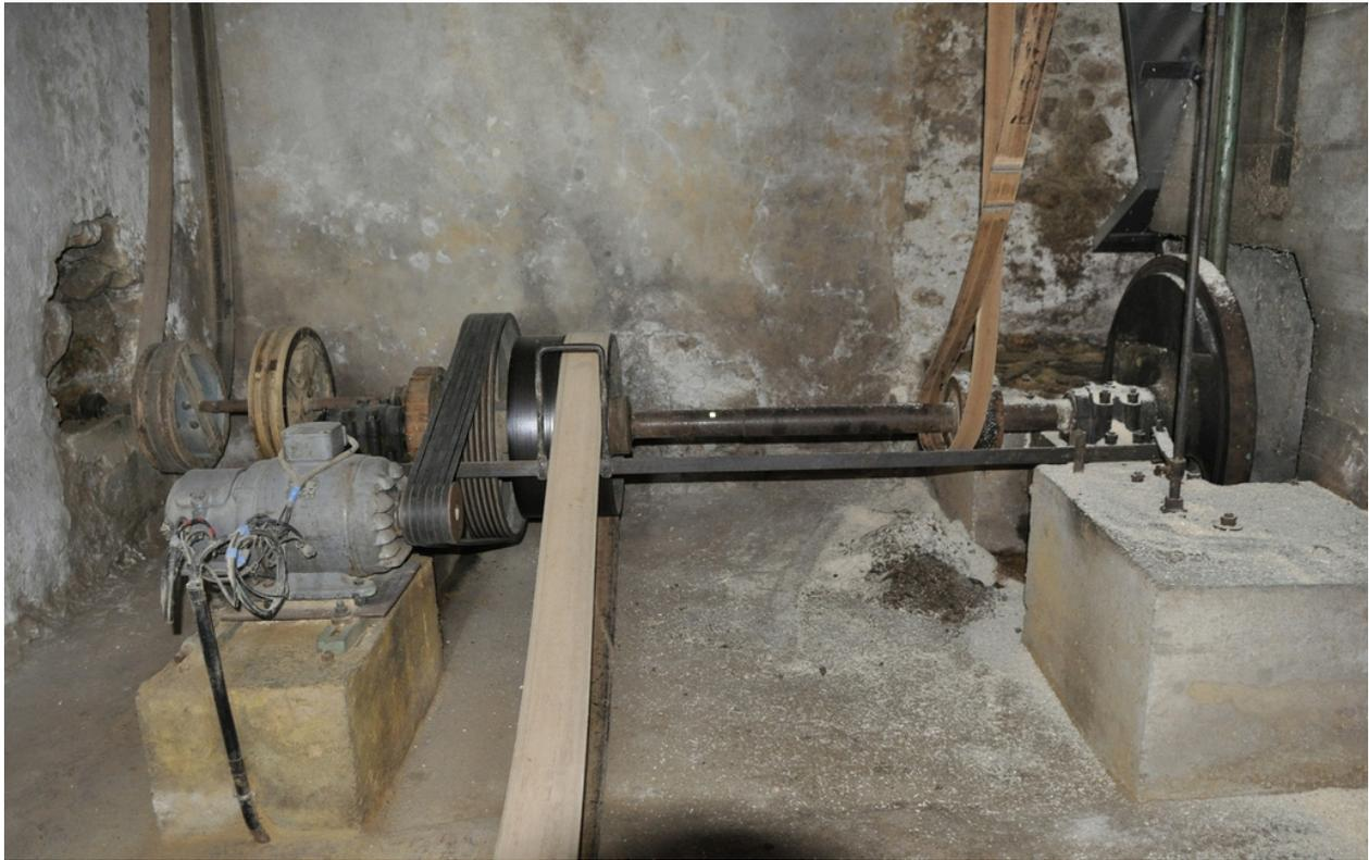
Vue du moteur électrique et des systèmes d'entraînement.
