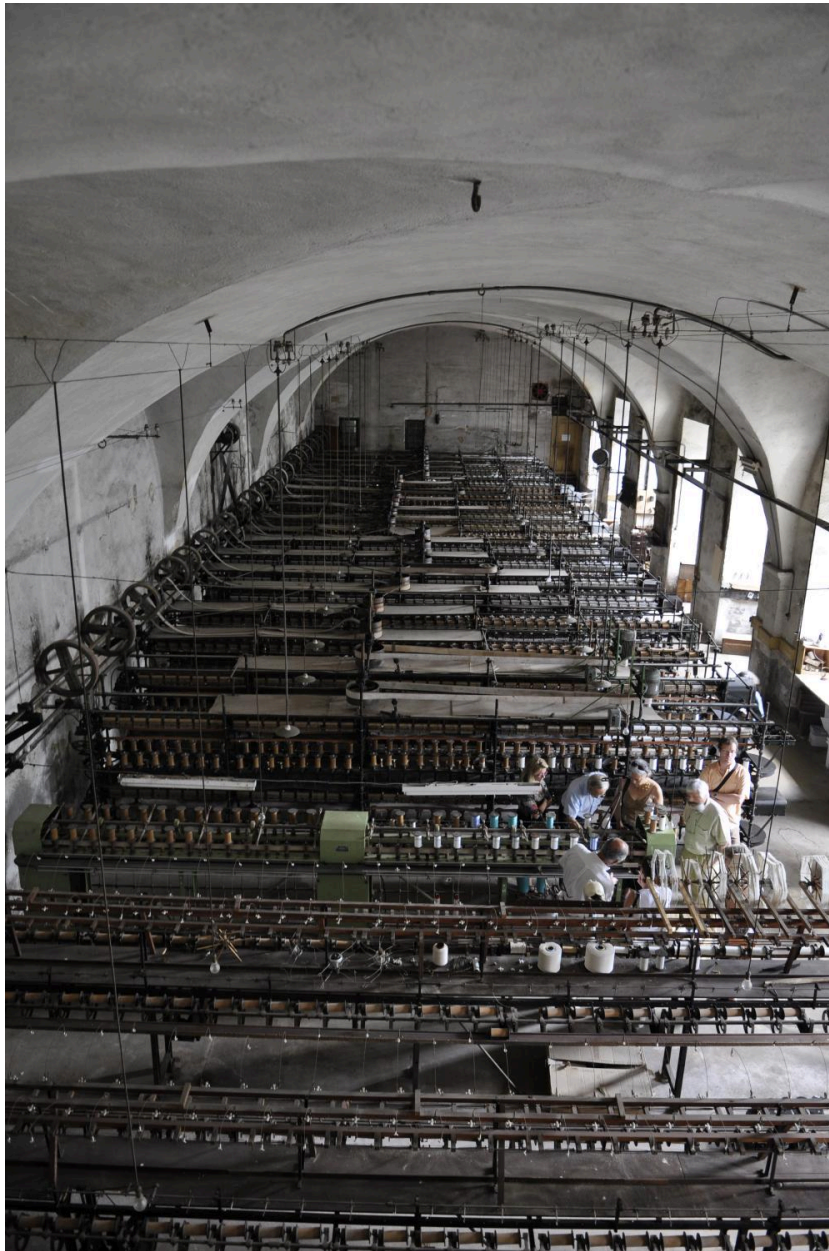
Vue intérieur de l'atelier principal avec variante voutée d'arêtes.
