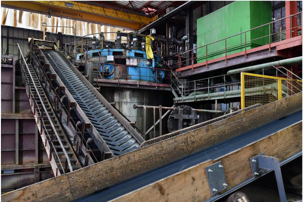
Atelier de lavage des betteraves : tapis élévateurs
