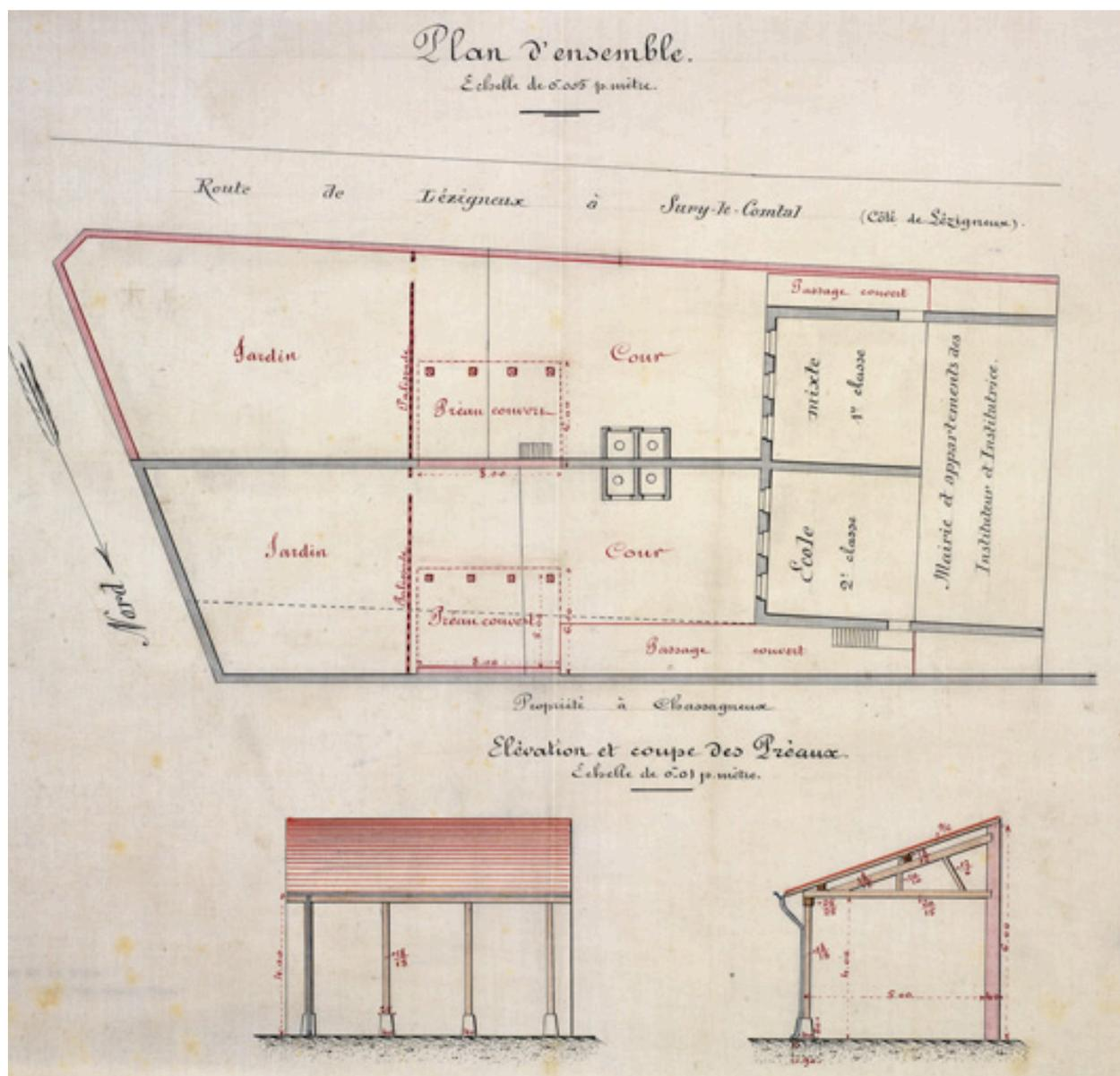
N°2. St-Thomas-la-Garde. Projet de construction de préaux couverts et de murs de clôture. Ensemble et détail des ouvrages.
