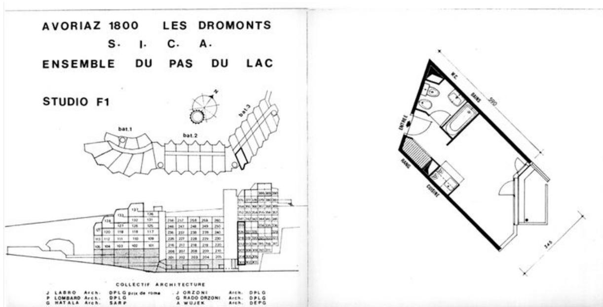
Plan masse ; schéma de répartition des appartement ; plan d'un studio F1 / Collectif Architecture, [1972]
