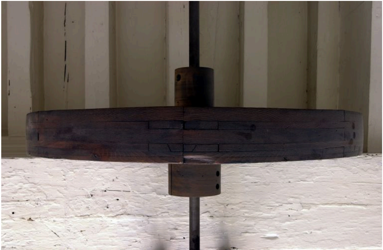
Bâtiment 3, 3e étage, pièce ouvrant sur la cour I et aménagée en atelier, mécanisme de transmission des anciennes machines, détail
