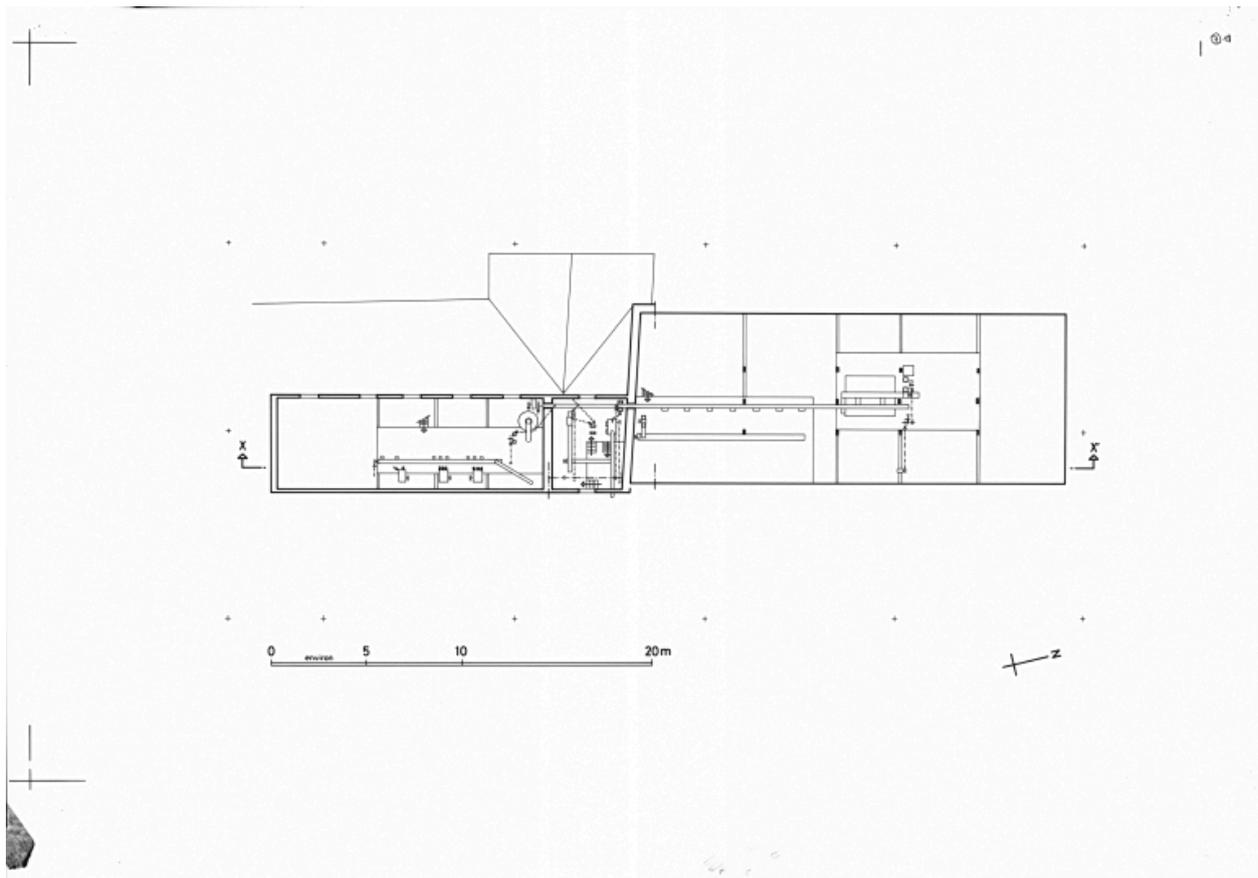
Moulin, plan au niveau du comble à surcroît : aspiration et têtes d'élévateur, croquis.
