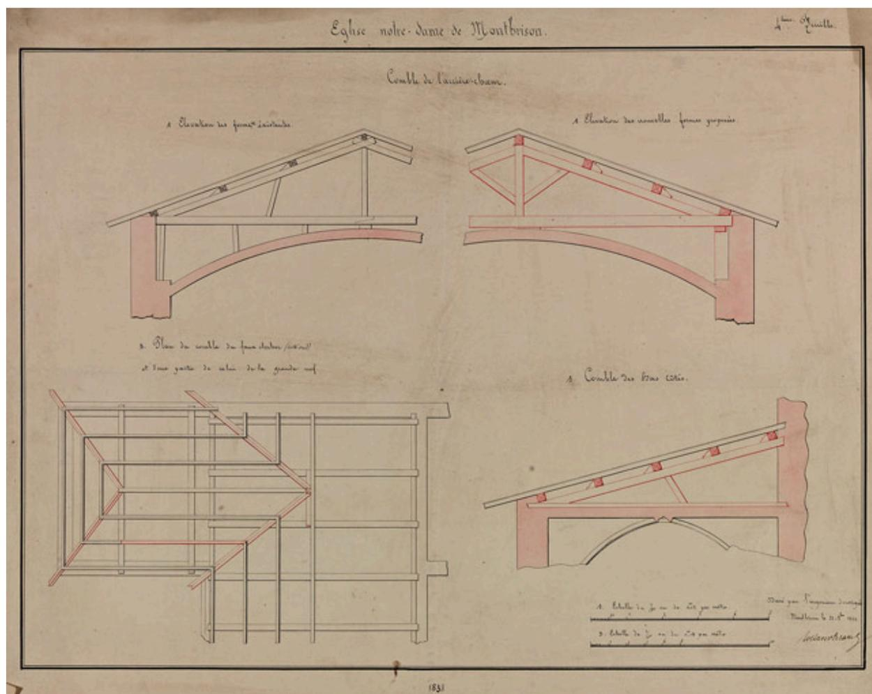
Eglise Notre-Dame de Montbrison. 4e feuille. Comble de l'arrière-choeur : A. élévation des fermes existantes. A. élévation des nouvelles fermes proposées. B. Plan du comble (..) Dessin : encre (plume et lavis coloré) sur papier. Ech. A. 1/50e ; B. 1/100
