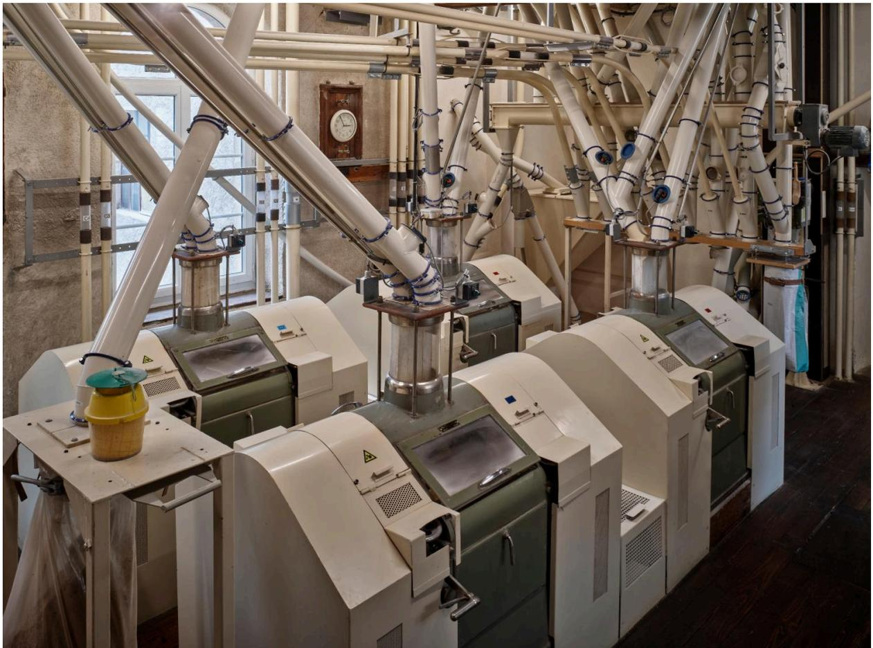
Rez-de-Chaussée : broyeurs, convertisseurs et claqueurs.
