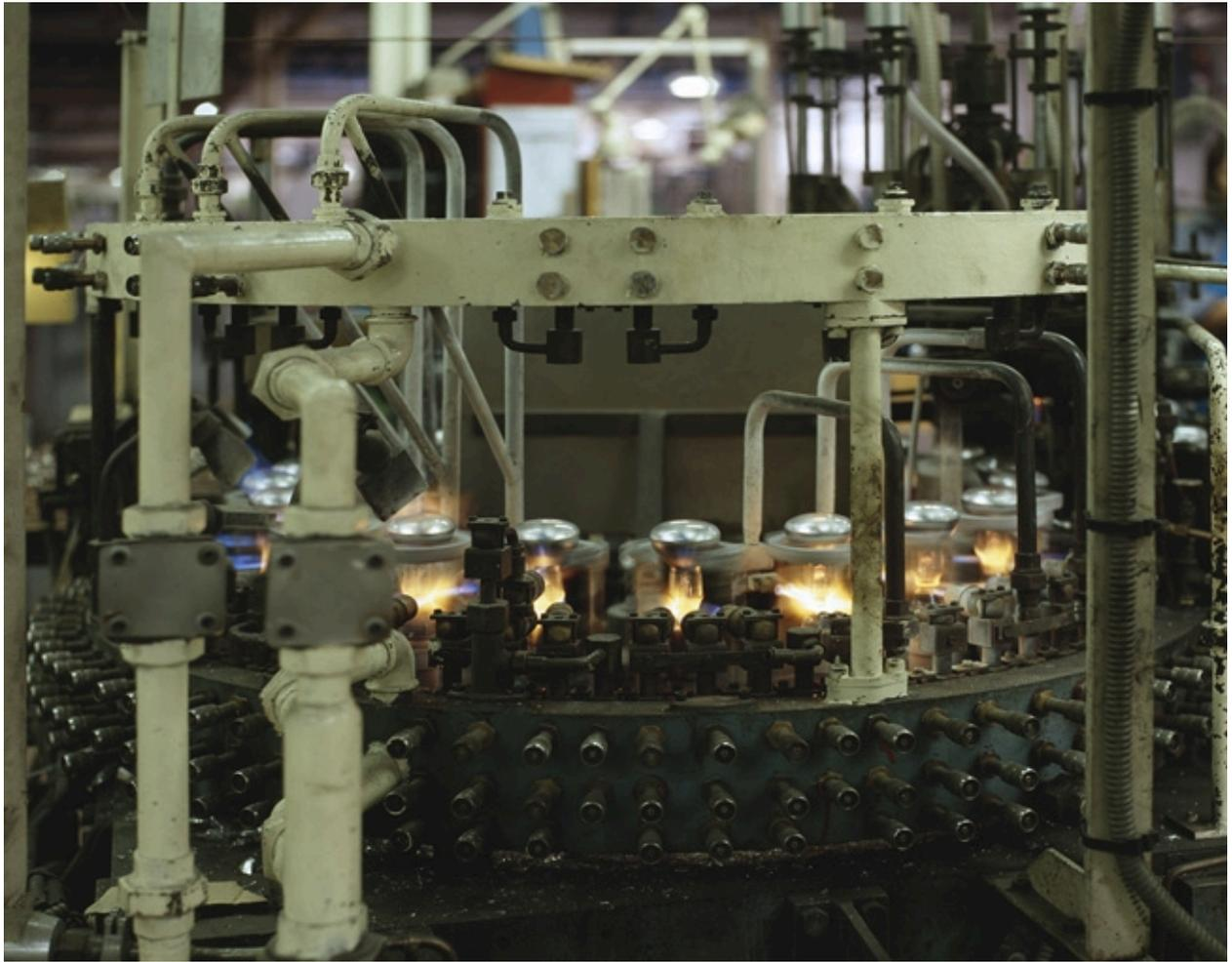
Fermeture du pied de l'ampoule
