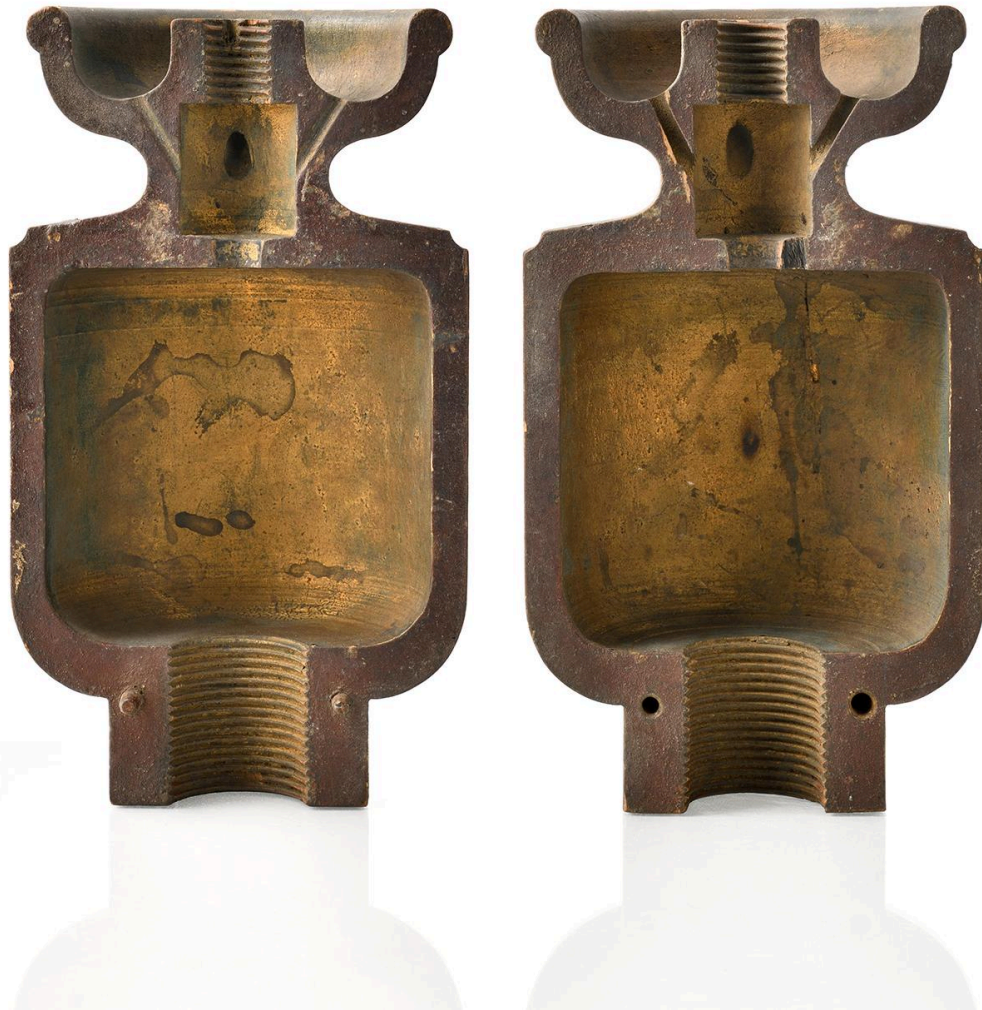
Modèle de graisseur, vue 1, en coupe
