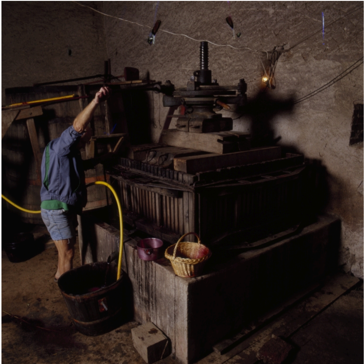
Cuvage à Champdieu (canton de Montbrison). Pressage du raisin dans le pressoir rectangulaire.
