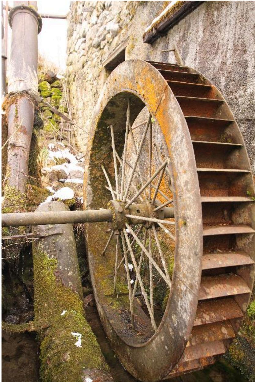
Roue à augets se trouvant à la sortie de la conduite forcée pincée
